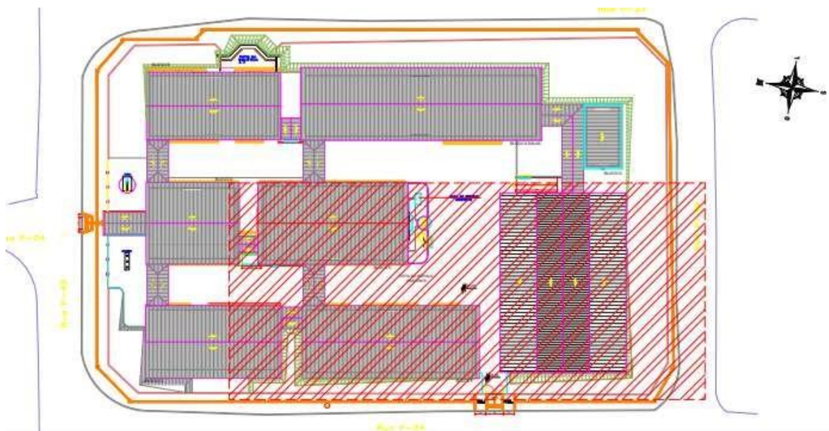
FIGURA 3 – ÁREA SUGERIDA PARA INSTALAÇÃO DO SISTEMA FV.
